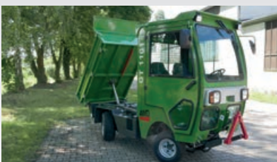
Dreiseitenkipper in Stahl und Aluminium ausgeführt
