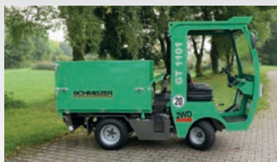
Dreiseitenkipper in Stahl und Aluminium ausgeführt
